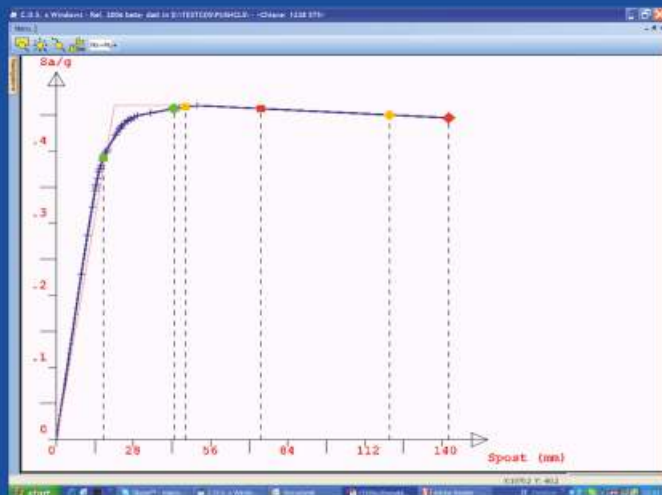
Curva di capacità Push-over con ramo softening
