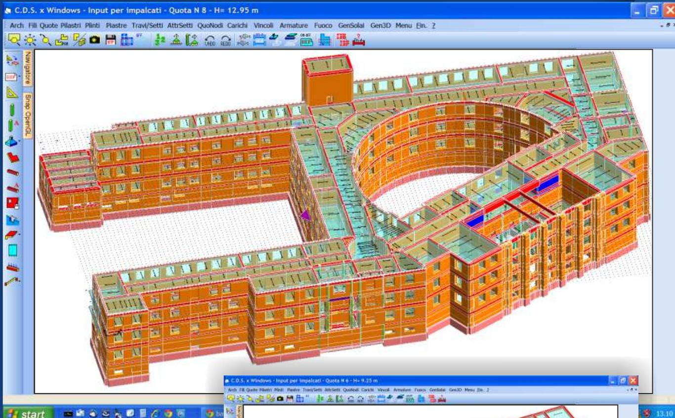
**CDMa Win** - Viste prospettive globale e di piano di una struttura in muratura
